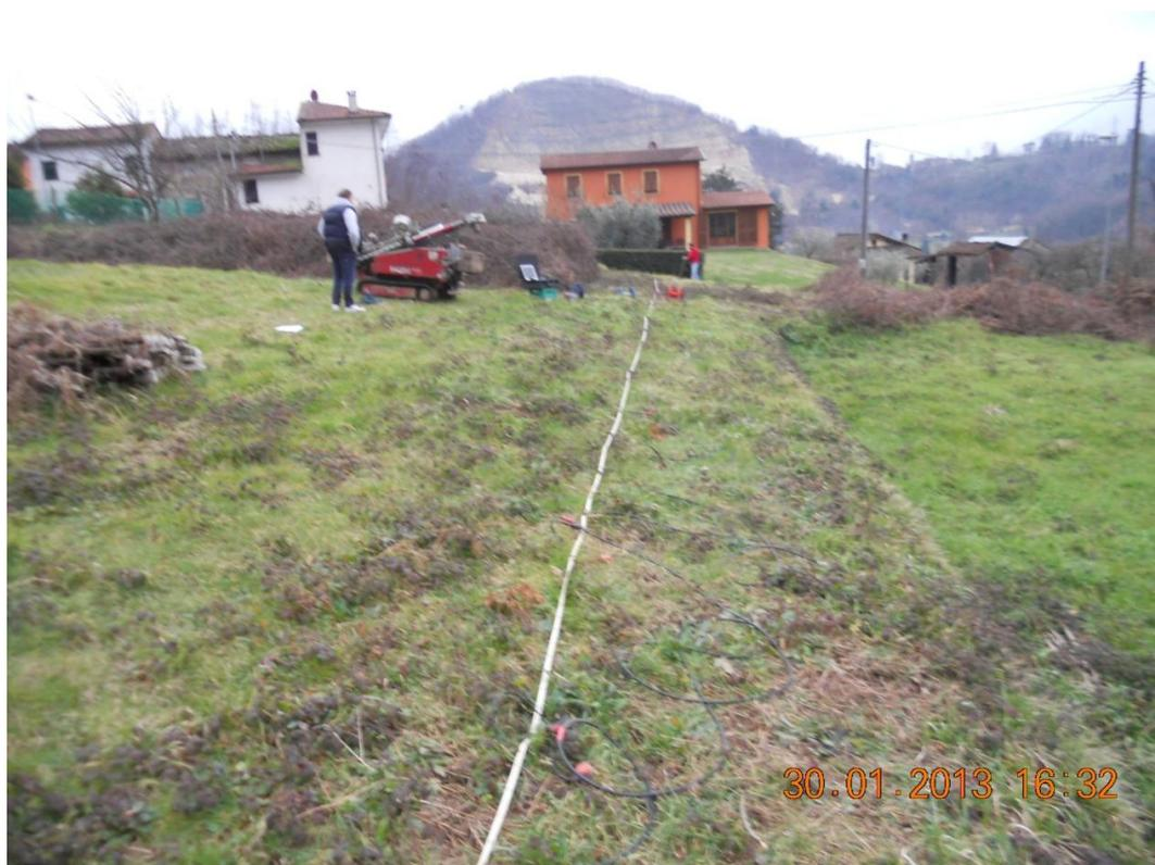
Figura 3 Stendimento sismico TOMO2 e MASW
