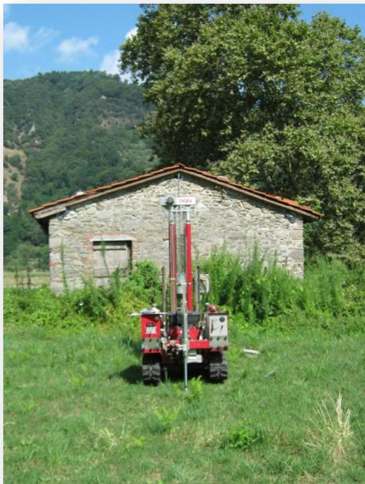
**Figura 1** – Prova penetrometrica dinamica superpesante P1 (12.08.2010)
