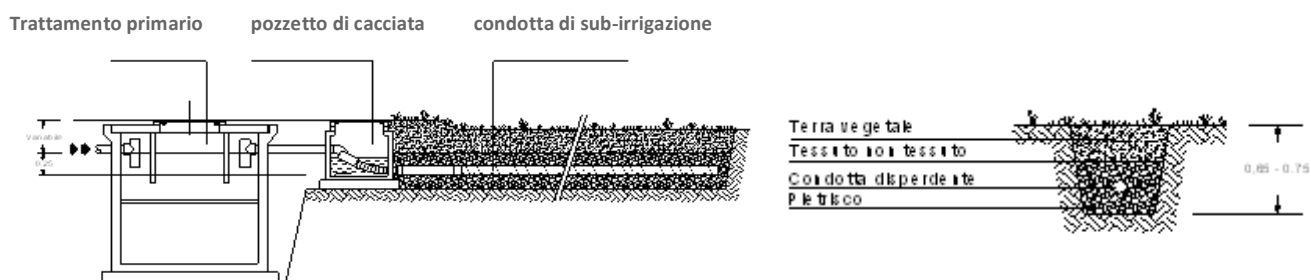
Schema di condotta disperdente per sub irrigazione
